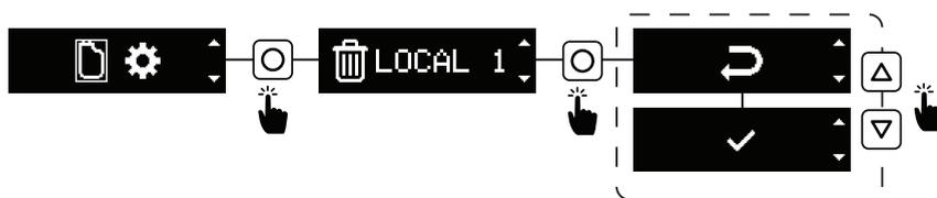
下記の指示に従って、本装置で解凍プロファイルを削除します。
